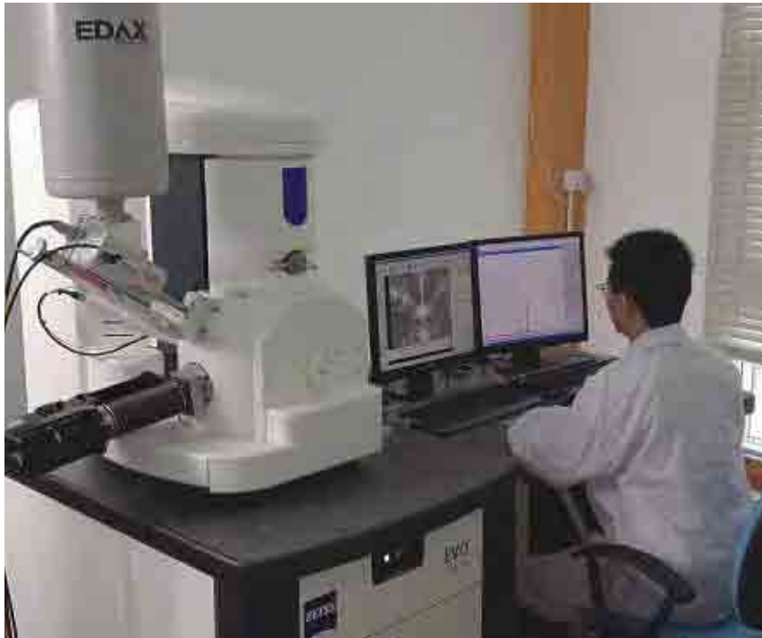
能谱仪（美国） Energy dispersive spectrometry (EDS)
